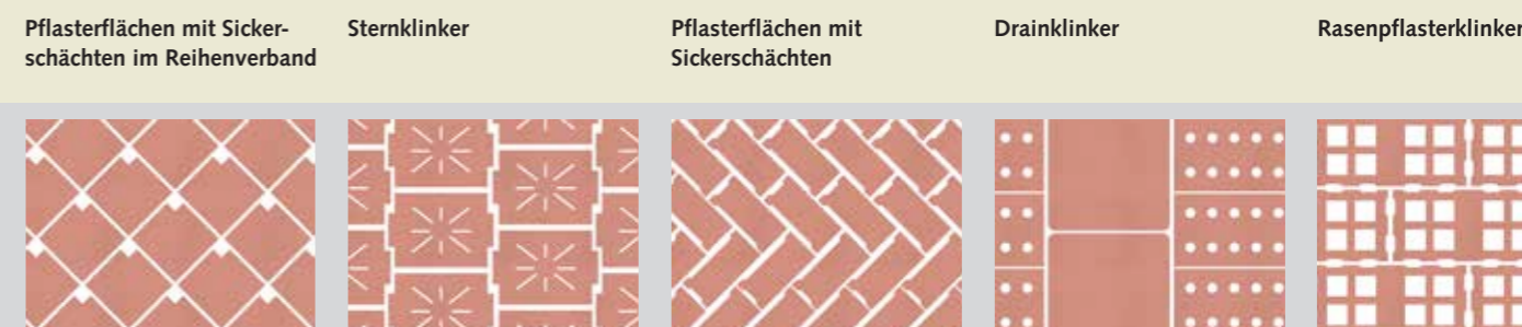
Abb. 6-3: Verschiedene Pflasterklinkerformate für versickerungsfähige Pflasterflächen
