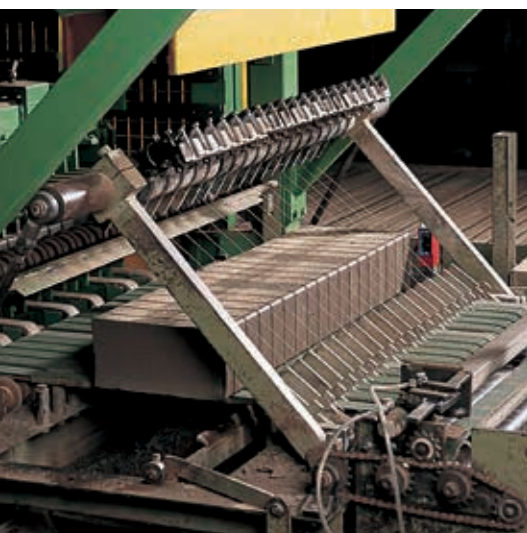
Der Tonstrang wird mit dem Harfenabschneider auf Steingröße geteilt
